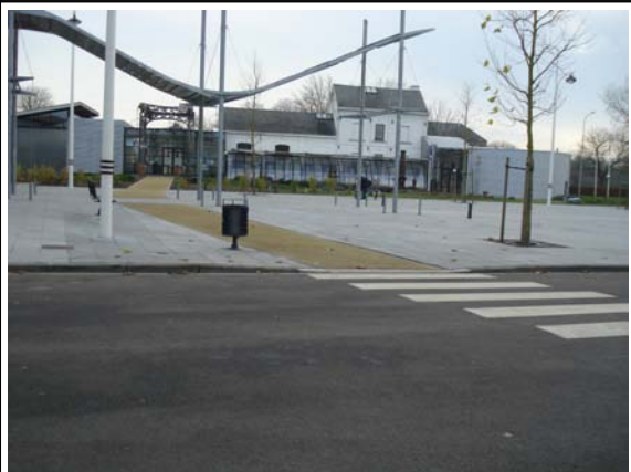
Photo 2 : Traversée. Poubelle dangereuse pour les malvoyants (pas d'éléments de protections)
